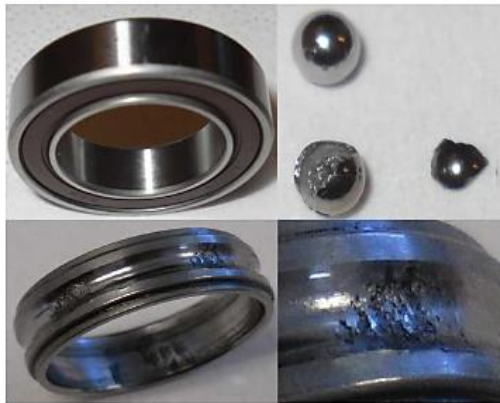
شکل (۳): سیگنال ارتعاشات بلبرینگ (الف)، قبل و بعد از خرابی بلبرینگها (ب)، [۳۸].
