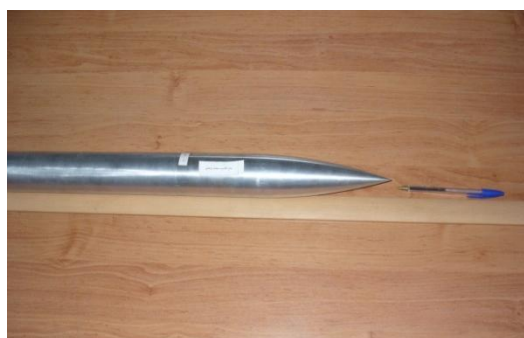
شکل (۳): مدل ساخته‌شده سیلندر با دماغه اجایو (Ogive)
