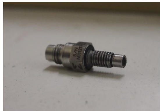
شکل (۲): یک نمونه از حسگر پیزورزیستيو مورد استفاده در آزمایش‌ها.
