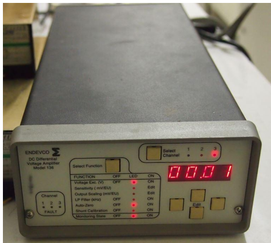
شکل (۳): آمپلی‌فایر مدل ۱۳۶ شرکت Endeveco.
