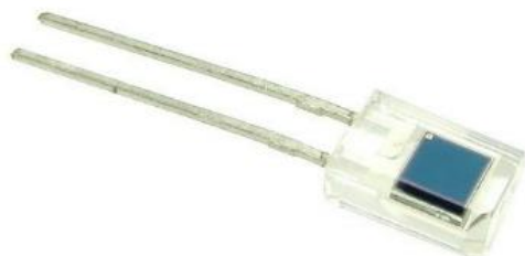
شکل ۲. لیزر گیرنده دستگاه سمیت‌شناسی آب با ماهی
