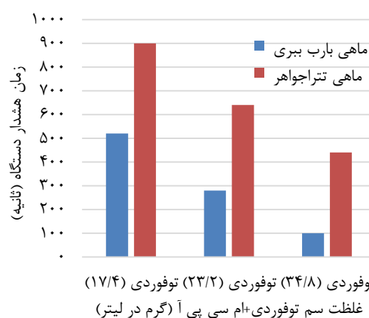
شکل ۸. مقایسه زمان هشدار دستگاه پس از ورود سم توفوردی+ام‌سی‌پی‌آ
