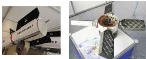
شکل (۱): بالک مشبک (سمت راست)، بالک معمولی متداول (سمت چپ)
