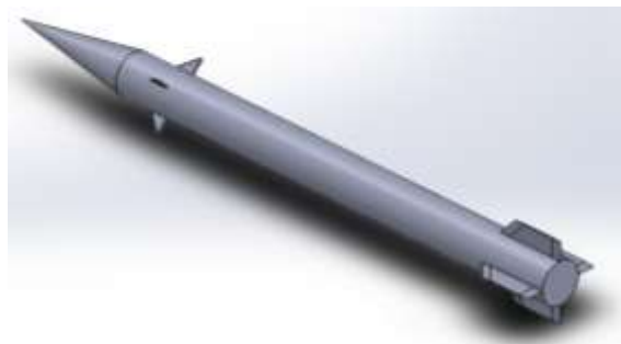
شکل (۲): هندسه موشک کانارد کنترل با بالک‌های معمولی
