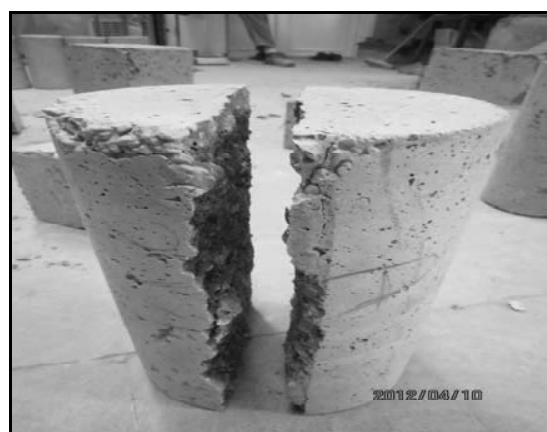
شکل ۱۲- مود شکست نمونه بدون الیاف (تصویر بالایی) و الیاف‌دار (تصویر پایینی) تحت آزمایش کشش برزیلی
