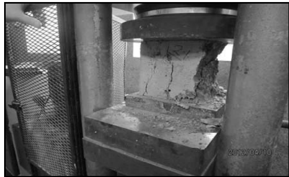
شکل ۵- آزمایش تعیین مقاومت فشاری بر روی نمونه مکعبی
