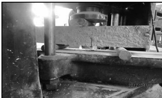
شکل ۶- آزمایش خمش بر روی نمونه تیر منشوری (الف) نمای شماتیک تست خمش، (ب) تست خمش بر روی نمونه شاهد، (ج) تست خمش بر روی نمونه الیافی
