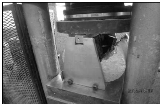
شکل ۶- آزمایش کشش برزیلی بر روی نمونه استوانه‌ای استاندارد
