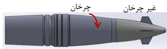
شکل (۳): پرتابه دوچرخشه ۵۷ میلی‌متری با افزونه جدید طراحی شده
