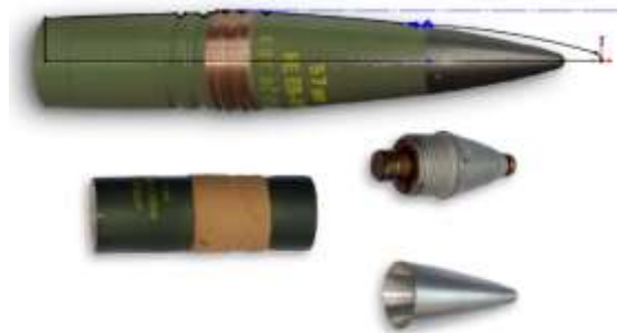
شکل (۲): پرتابه ۵۷ میلی‌متری به همراه ماسوره و نمایش خطوط دوبعدی محدوده پرتابه دوچرخشه
