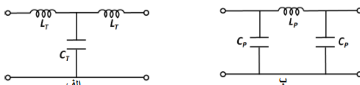
شکل ۹- شبکه‌های تطبیق امپدانس برای کابل‌ها (الف) از نوع T و (ب) از نوع \pi [1]
