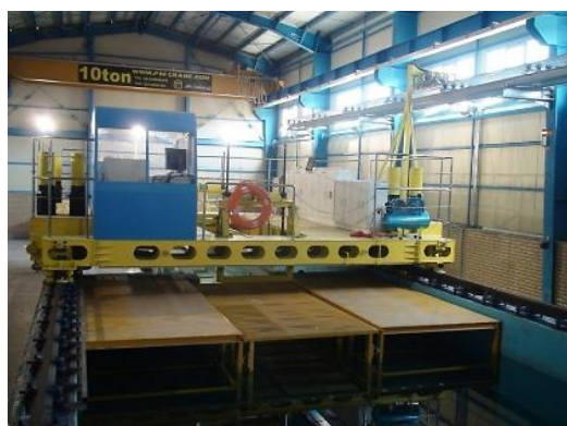
شکل ۲: نمایی از اربابه کشش حوضچه آزمایشگاه ملی دریایی خلیج فارس
