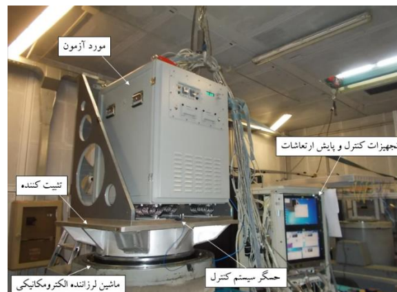
شکل (۱): پیکربندی یک آزمون محیطی ارتعاشات اتفاقی.
