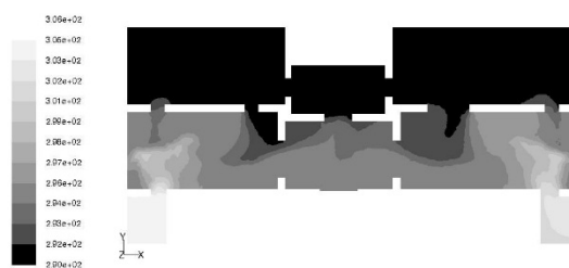
شکل (۲۱). کانتور توزیع دمای هوا بعد از مداخله ۲ در ارتفاع 0/7\text{m} برحسب کلوین
