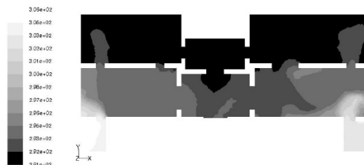
شکل (۲۹). کانتور توزیع دمای هوا بعد از مداخله ۴ در ارتفاع ۰/۷m برحسب کلونین
