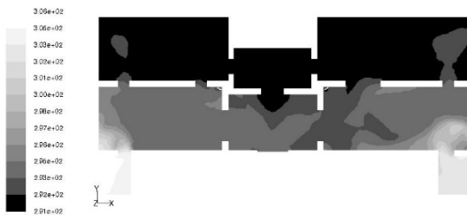
شکل (۳۰). کانتور توزیع دمای هوا بعد از مداخله ۴ در ارتفاع ۱/۴m برحسب کلونین
