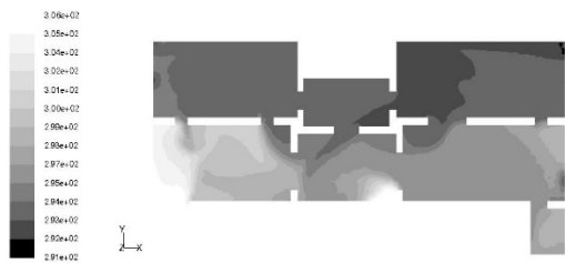
شکل (۹). کانتور دمایی وضع موجود بر اساس داده‌های تجربی: توزیع دما در ارتفاع ۰.۷m برحسب کلوین (K)
