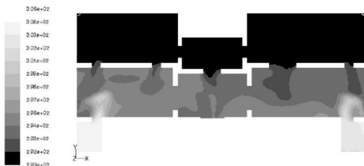
شکل (۲۵). کانتور توزیع دمای هوا بعد از مداخله ۳ در ارتفاع 1/4\text{m} برحسب کلوین
