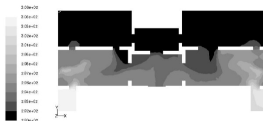
شکل (۲۲). کانتور توزیع دمای هوا بعد از مداخله ۲ در ارتفاع 1/4\text{m} برحسب کلوین
