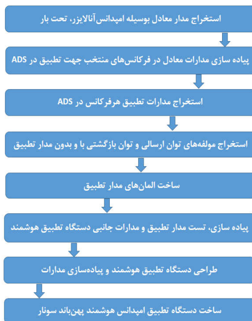
شکل (۲) نمای بلوکی شبکه تطبیق امپدانس ساخته شده
