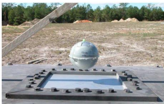
شکل ۱. چینه‌آزمایش جهت بررسی تأثیر انفجار بر رفتار صفحه فولادی [۲۵]
