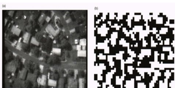
شکل (۵): تصویر گرفته شده توسط موشک (a) تصویر خاکستری، (b) تصویر پس از تبدیل باینری [۶]
