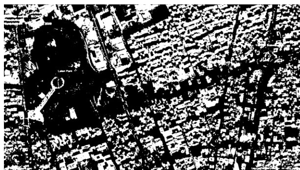
شکل (۱۲): تبدیل تصویر خاکستری چند سطحی به تصویر دوسطحی (باینری)
