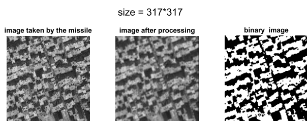
شکل (۱۴): تصویر گرفته شده توسط موشک، تصویر پس از پردازش تصویر، تصویر باینری شده (به ترتیب از چپ به راست)
