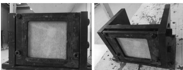
شکل (۱۰): نحوه قرارگیری نمونه بتن پارچه‌ای در دستگاه تفنگ گازی
