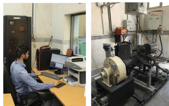
شکل (۱): تجهیز موتور در آزمایشگاه جهت کالیبراسیون
