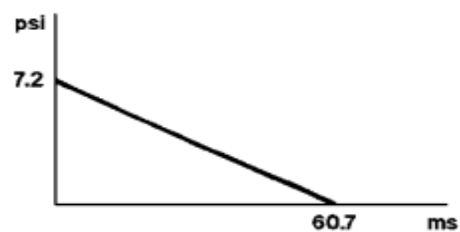
شکل ۷. مشخصات بارگذاری تیر بتنی [۲۱]
