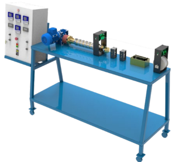
شکل (۳): مدل کامل دستگاه آغشته‌سازی الیاف کربن.
