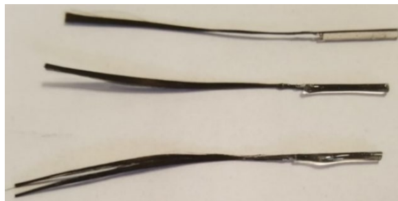
شکل (۴): آماده‌سازی نمونه‌ها جهت انجام تست کشش.
