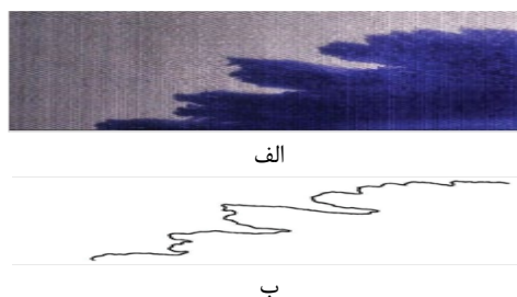
شکل ۴. الف) عکس ضبط شده ب) پردازش تصویر همان عکس با استفاده از کد نرم افزار متلب
