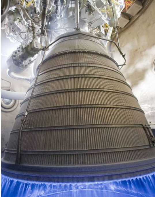
شکل (۲): چیدمان لوله‌های خنک‌کننده بر روی محفظه [۱۹].
