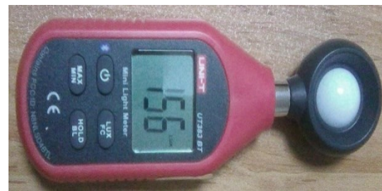
شکل (۷): اندازه گیری لوکس نور پراکنده شده با استفاده از لوکس متر
