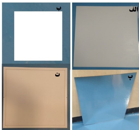
شکل (۴): قطعات بکار رفته در مجموعه بازتابنده-پراکنده‌کننده. الف: قطعه پخش‌کننده کدر ب: قطعه پخش‌کننده براق پ: قطعه بازتابنده ت: مجموعه کامل با نگهدارنده
