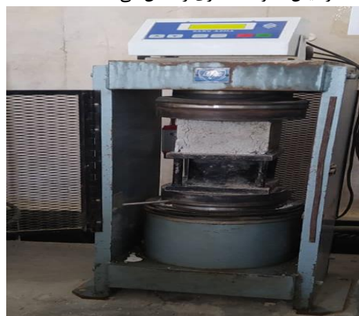
شکل (۲): نحوه تنظیم دستگاه آزمایش مقاومت فشاری و نمونه بتنی
