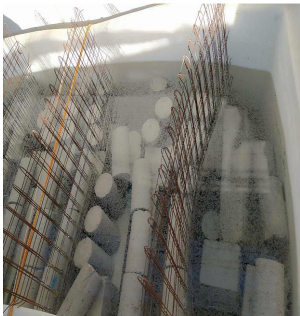
شکل (۱): عمل‌آوری نمونه‌های بتنی در آب
