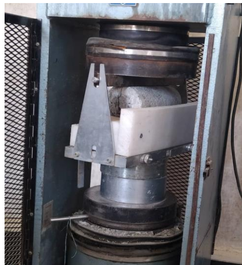
شکل (۴): آزمایش کشش غیر مستقیم
