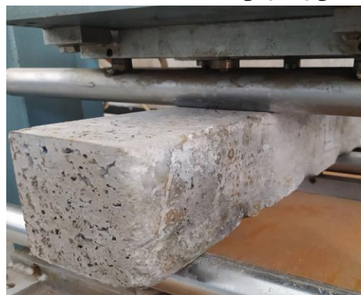
شکل (۸): نحوه تنظیم دستگاه UTM و نمونه بتن
