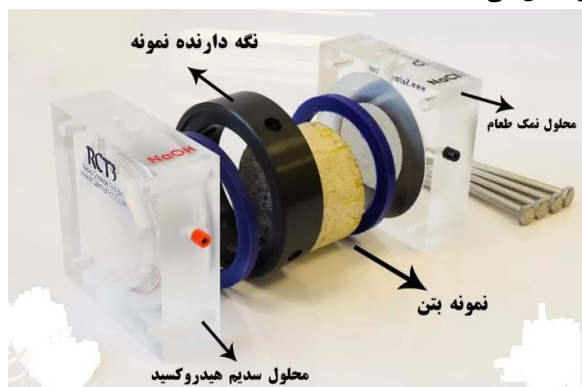
شکل (۶): دستگاه آزمایش نفوذ تسریع شده یون کلر
