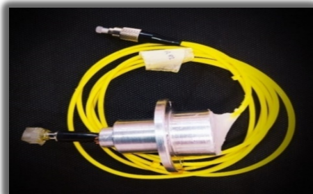
شکل (۵). حسگر فیبر نوری فابری-پرو با لایه Rigid PVC
