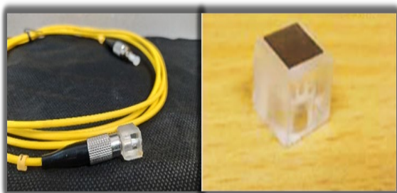
شکل (۲). سمت راست: نمونه‌ای از لایه ساخته شده، سمت چپ: لایه قرار گرفته روی فیبر نوری
