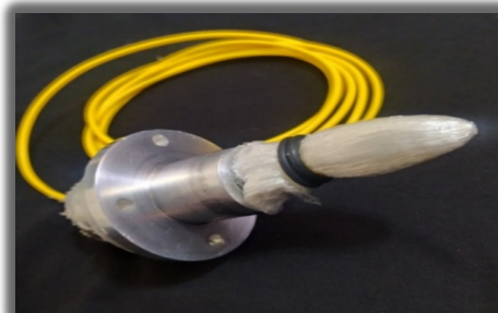
شکل (۶). حسگر فیبر نوری فابری-پرو با لایه Soft PVC
