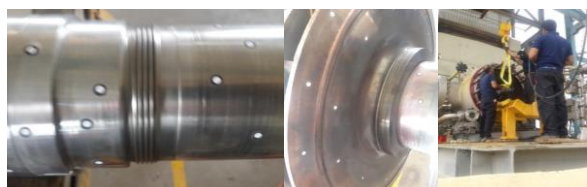
شکل ۲: نقطه گذاری بر روی کمپرسور برای ابعاد برداری ابرنقاط.
