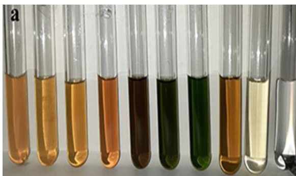
شکل (۸): پاسخ رنگی عصاره پوست بادمجان سیاه در رنج pH ۳ تا ۱۲ (از چپ به راست) (شکل ۸a). مقادیر جذب نوری عصاره پوست بادمجان سیاه تغییر رنگ یافته در طول موج ۳۰۰ تا ۸۰۰ نانومتر (شکل ۸b).
