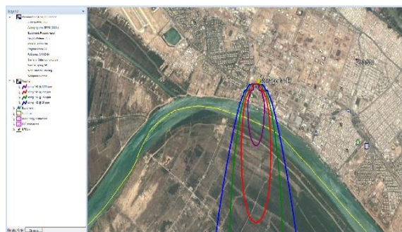
شکل (۷): نشت آمونیاک در اثر گسستگی و ترک‌بند مخزن در فصل بهار ۱۴د
