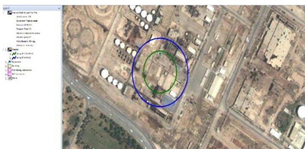
شکل (۱): میزان تشعشع ناشی از آتش‌سوزی مواد در اثر ترکیدن مخزن در فصل بهار 14^{\circ}\text{D}
