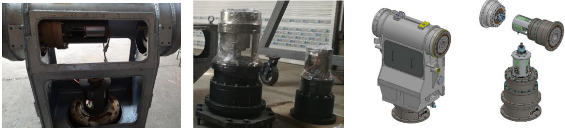
شکل ۶. تصاویر موتور گشتاوری و پدستال (الف) طراحی نقشه موتورها با سالیدورک. (ب) طراحی پدستال با سالیدورک. (ج) موتورهای انتخاب شده. (د) نصب موتورها بر روی پدستال
