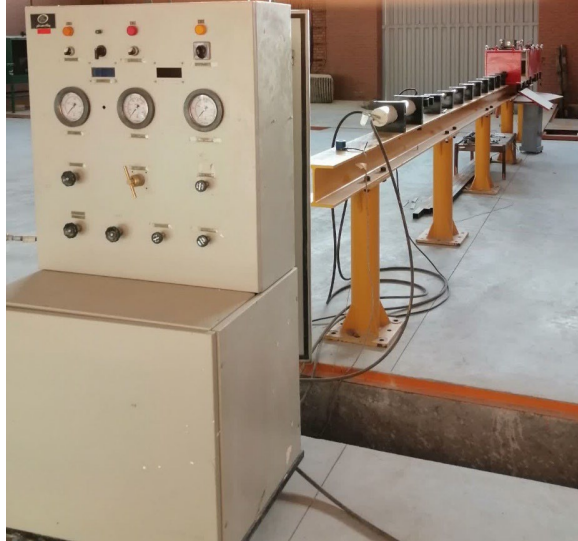
شکل (۲): دستگاه تفنگ گازی برای تست ضربه.
