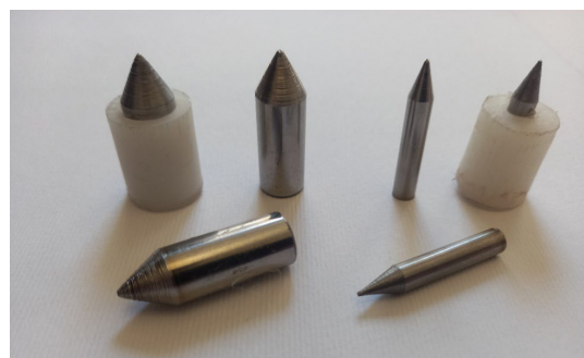
شکل (۱۶): مقایسه پرتابه و سابوت با دو قطر ۵ و ۱۰ میلی‌متر.
