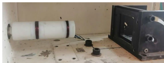
شکل (۴): موقعیت قرارگیری نگه‌دارنده و سنسور محاسبه سرعت ورودی در انتها لوله تفنگ گازی.
