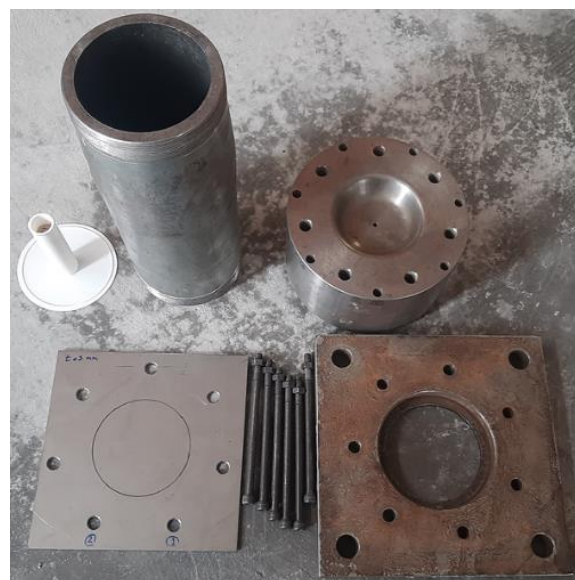
شکل (۴): نمایی از تجهیزات آزمایشگاهی شامل قالب مادگی، نکه‌دارنده، لوله انفجار، نمونه ورق.
