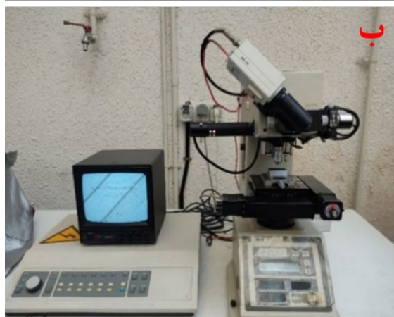
شکل (۴): الف) میکروسکوپ نوری؛ ب) میکروسختی سنجی مورد استفاده در این تحقیق.
