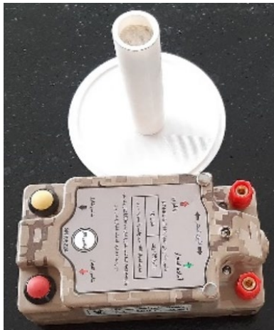
شکل (۲): نگاه‌دارنده پلیمری طراحی شده با پرینتر سه‌بعدی به همراه تجهیزات برای اعمال بار انفجاری.
