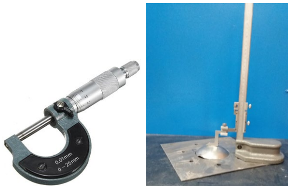
شکل (۵): تجهیزات اندازه‌گیری پروفیل تغییر شکل و ضخامت ورق.
