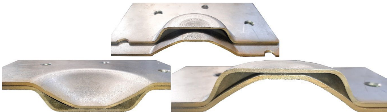
شکل (۱۳): نمای برش خورده و داخلی نمونه ورق‌های تغییرشکل‌یافته در فرآیند شکل‌دهی انفجاری زیرآب با قالب مادگی بدون راهگاه.
