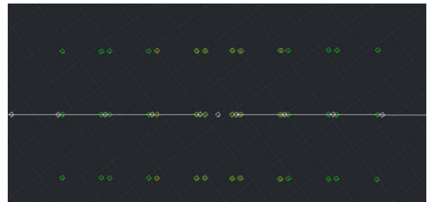
شکل (۱۰). مقایسه پلیت‌های محاسباتی و مختصات نصب برای دهانه SW03. نقاط سبز مربوط به خروجی برنامه و نقاط نارنجی مختصات برداشتی مرحله نصب است
