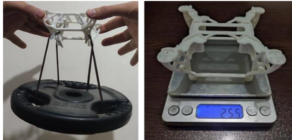
شکل (۱۸): الف) اندازه‌گیری وزن بدنه ساخته‌شده توسط ترازوی دیجیتال؛ ب) تحمل وزنه ۲.۵ کیلوگرمی.
