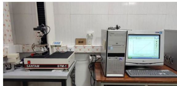
شکل (۱۳): بدنه میکروپهپاد ساخته‌شده، برای انجام آزمایش و تست بارگذاری قرار داده گرفته است.
