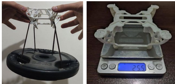
شکل (۱۸): الف) اندازه‌گیری وزن بدنه ساخته‌شده توسط ترازوی دیجیتال؛ ب) تحمل وزنه 2.5 کیلوگرمی.
