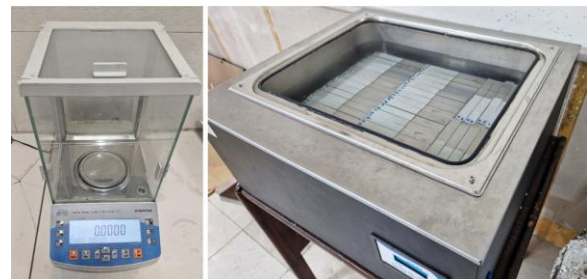
شکل (۳): قرار گرفتن نمونه‌ها در حمام آب گرم و ترازوی دیجیتال با دقت ۰/۱ میلی‌گرم.
