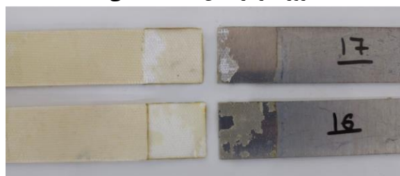
شکل (۱۲): سطوح شکست نمونه‌های تحت پیرشدگی ۷۵ روزه در آزمایش شبه‌استاتیکی.
