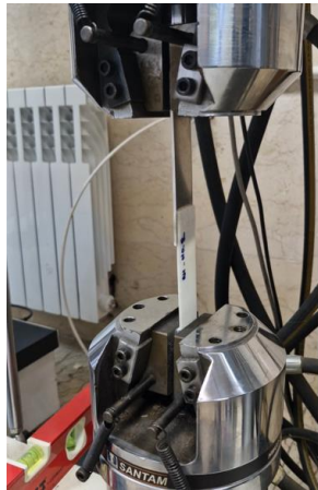
شکل (۴): قرارگیری اتصالات چسبی داخل فک دستگاه به منظور انجام آزمایش کشش.
