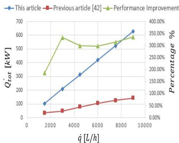
شکل (۲۰): انتقال حرارت کل از هندسه بهبودیافته نسبت به پژوهش پیشین
