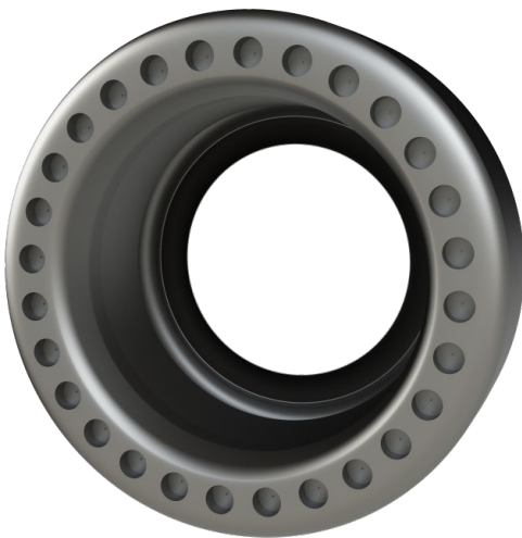
شکل (۱): تصویر کامل محفظه احتراق موتور ALF502
