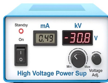
شکل (۳): منبع تغذیه مستقیم منفی ولتاژ بالا
