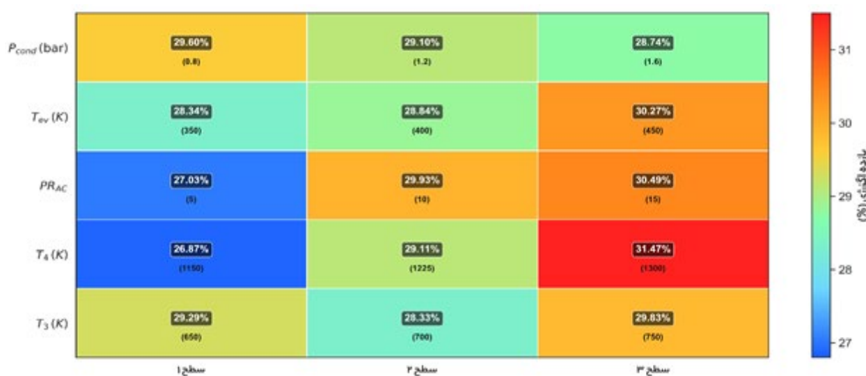
شکل (۴): مقادیر میانگین بازده انرژی سیکل بر اساس سطوح پارامترهای مؤثر
