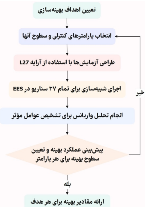
شکل (۱): فلوچارت فرآیند بهینه‌سازی با استفاده از روش تا گویی
