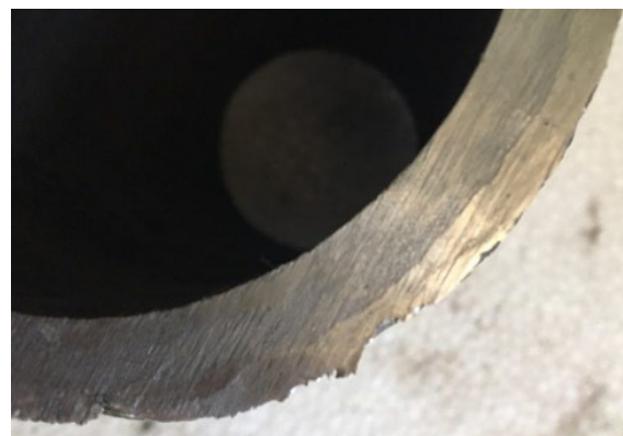
شکل ۵: تصویر قطعه پس از آزمون ضربه
